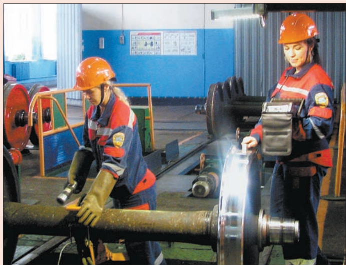
Дефектоскописты Лилия ШУКИНА и Татьяна ДЕДКОВА проверяют колесную пару, от исправности которой зависит безопасность движения поездов.
