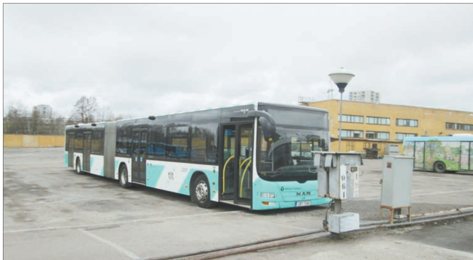
Для гибридных автобусов на конечных остановках установлены зарядные станции.
